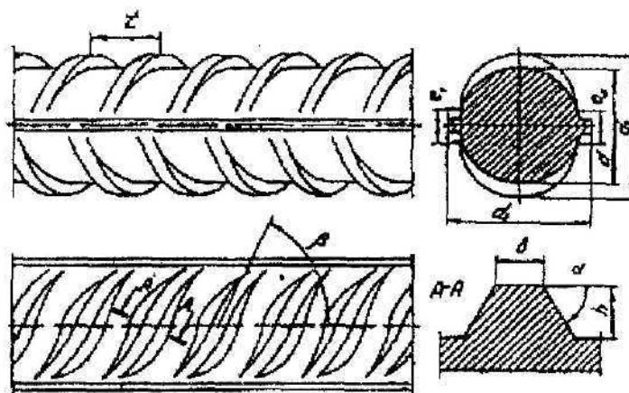
Рисунок 1. Периодический профиль горячекатаного арматурного проката
